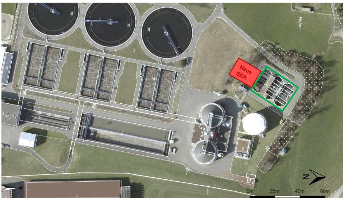
Abbildung 1: Lage der geplanten Schlammentwässerungsanlage (SEA) auf dem Areal der Kläranlage Hofen; grün: ehemalige Emscherbrunnen.
